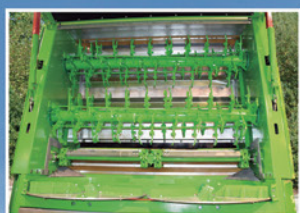
2 cilindros horizontales con tabla de esparcimiento (2 x Ø 1040 mm)
